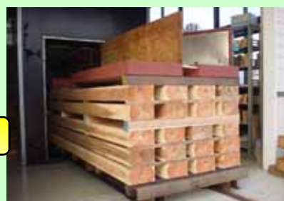
蒸気式乾燥機を用いた木材乾燥
