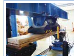
曲げ強度試験 作製したCLTを曲げ、強度をみる
