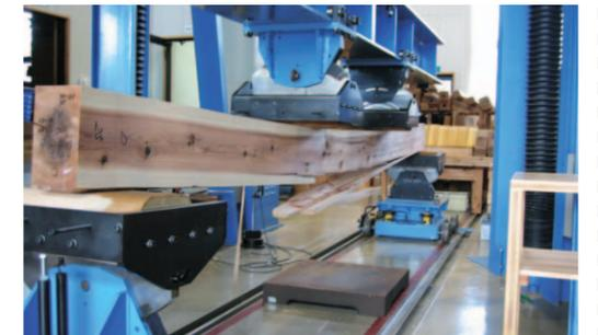
スギ梁材の強度試験
