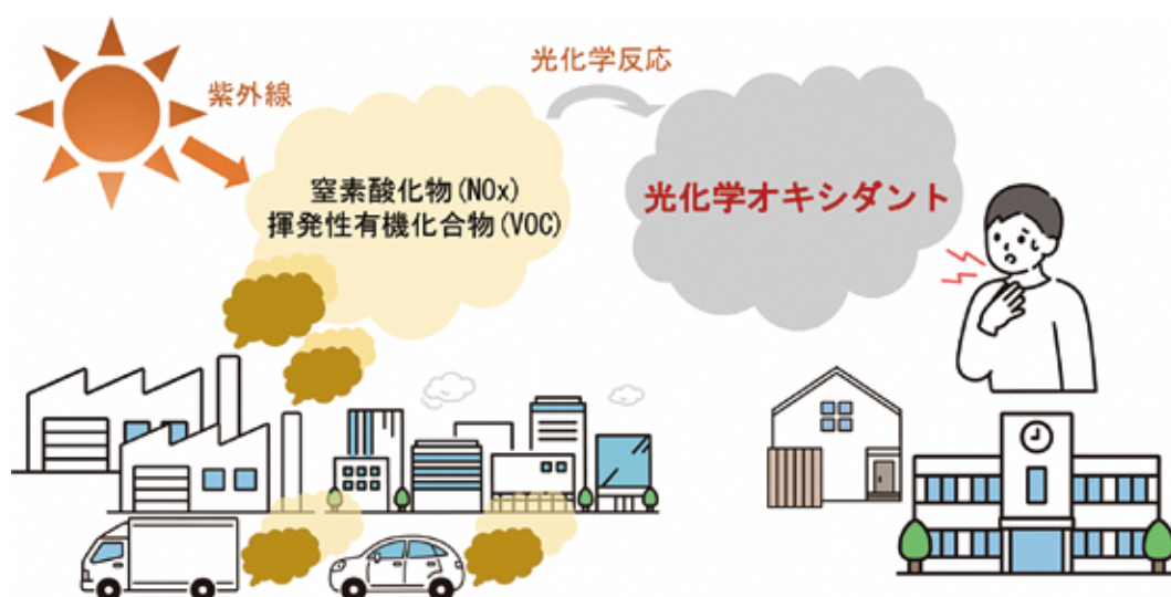
図-1 光化学オキシダント生成の仕組み
