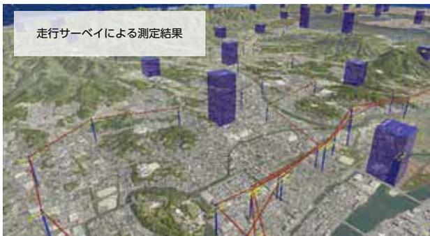
従来の平面上の地図では、走行サーベイでの走行ルートと各地点での線量率の値をわかりやすく同時に示すのは難しかったのですが、高さで線量率の大きさを表す細い円柱とそれらを結ぶ赤い線で走行ルートを表すことによって、走行サーベイ車がどういう経路を通過して今どの辺りにいて、その経路の線量率がどのくらいであったかが一目瞭然で分かります。
