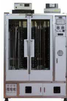
図1 ダストモニタシステム
