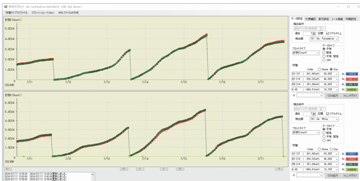
図3 ダストモニタシステムの測定結果（平常時は自然放射線のみ測定される）
