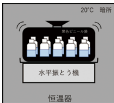
図3 100日分解試験の方法
