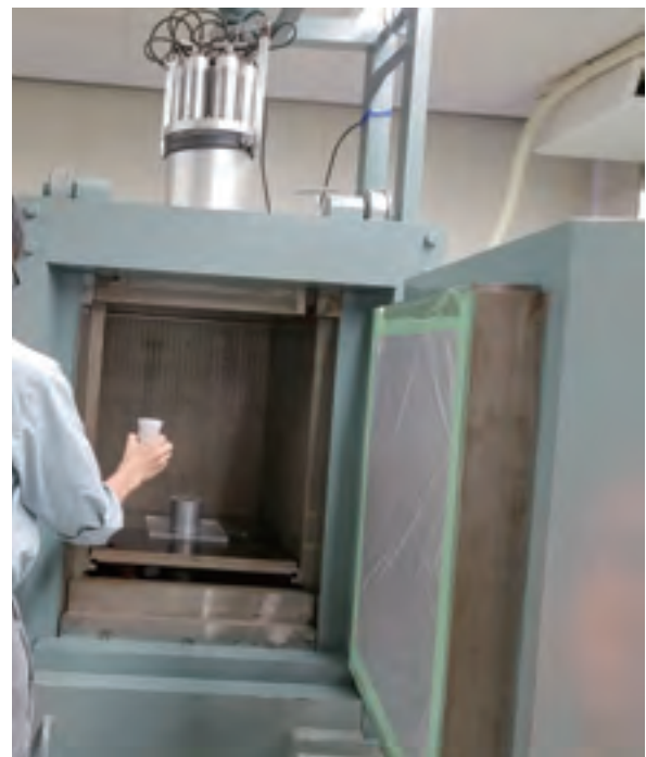
写真2：ガンマ線を測定するゲルマニウム半導体検出器
