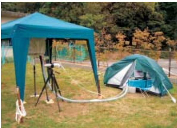
野外での放射性核種の測定（ゲルマニウム半導体検出器）
