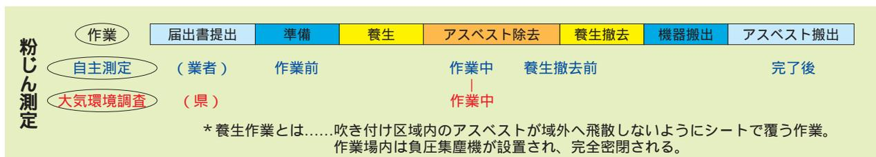
図2 アスベスト除去工事及び粉じん測定工程
