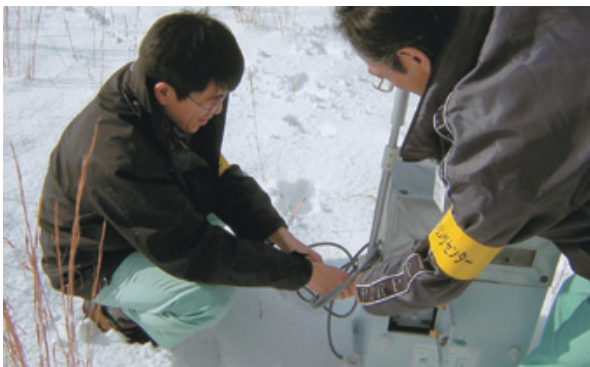
可搬型モニタリングポストの設置
