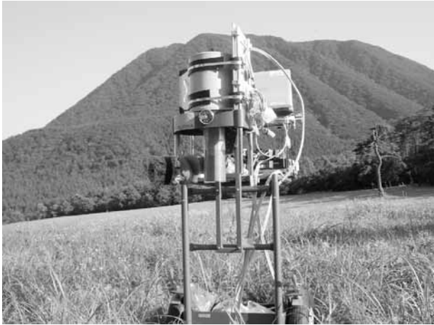
写真 三瓶山でのIn-Situ Ge測定
