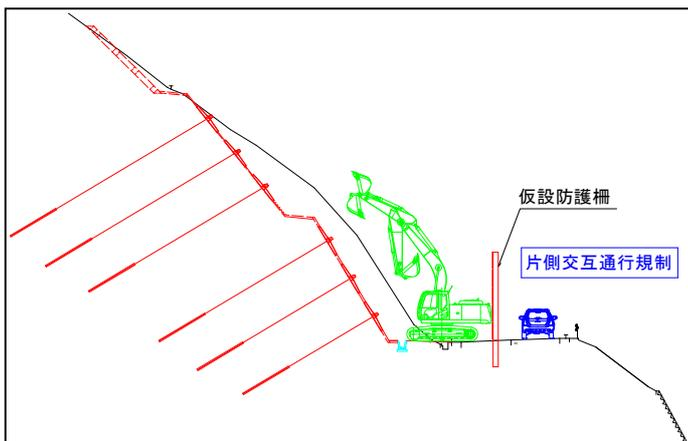
当現場は急勾配な斜面なうえ掘削幅が狭いため、安全で効率的に施工可能な無人の掘削機により施工を行いました。
