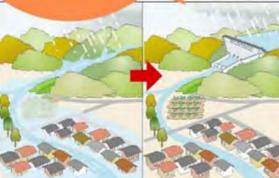
大雨が降ると、ダムに水を貯め、安全な量だけを下流へ流します。
