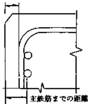
図3-1 鉄筋のかぶり
