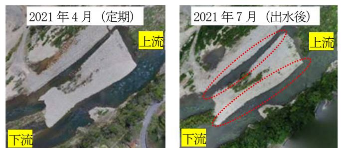
図2 2020年11月に施工した置土の出水前後の状態(赤い点線で囲った部分は土砂が流出したと考えられる箇所)
