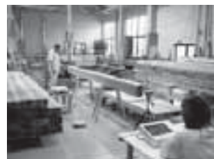
写真1 縦振動法による動的ヤング係数の測定
