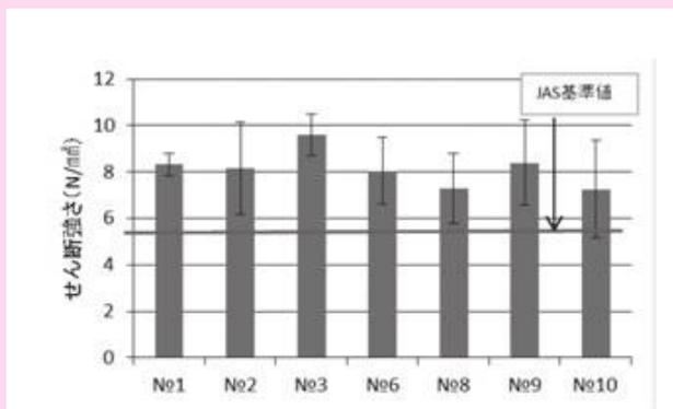
図-1 幅はぎ接着層のせん断強さ
