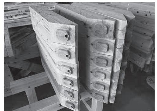
写真2 県内プレカット工場で加工したトラス材料の一例
