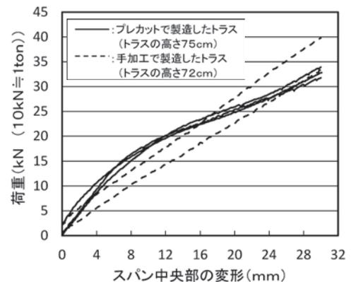
図1 プレカットと手加工で製造したハウトラスの曲げ性能の比較
