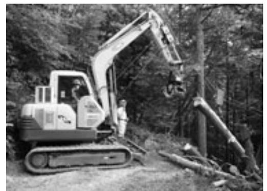
高性能林業機械（スイングヤーダ）を利用した集材作業
