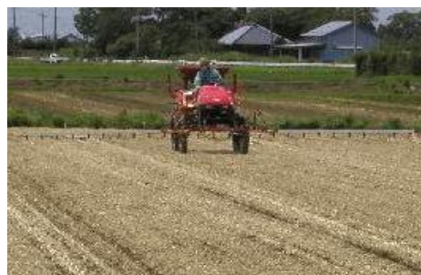
第 6 図 ブームスプレーヤーによる雑草防除
