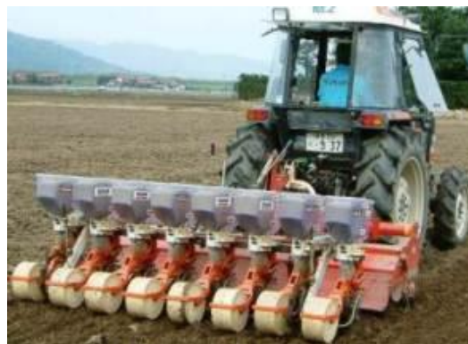
第1図 碎土・播種・施肥同時作業機
