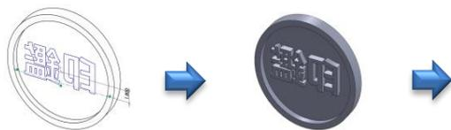
※3次元CADと3Dプリンタを使ったスタンプを制作します。
