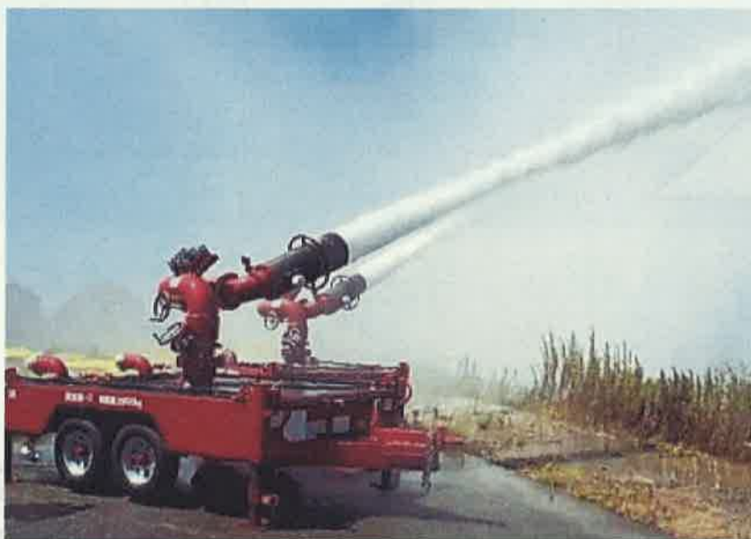
大容量泡放水砲システムによる放水訓練 (大阪・和歌山広域共同防災協議会)
