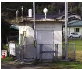
モニタリングポスト(ステーション) 発電所周辺に設置され、環境放射線量や気象データ等を連続測定するための施設です。
