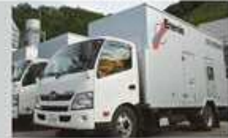
高圧発電機車
