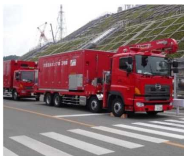
大型送水ポンプ車
