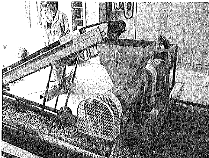
写真3 植織機による竹のパウダー化
