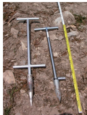
写真3 吉賀調査地で使用したコンテナ苗専用の植栽器具
